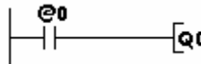
Figura 231: El esquema a introducir en un controlador lógico con diagrama de contactos.
